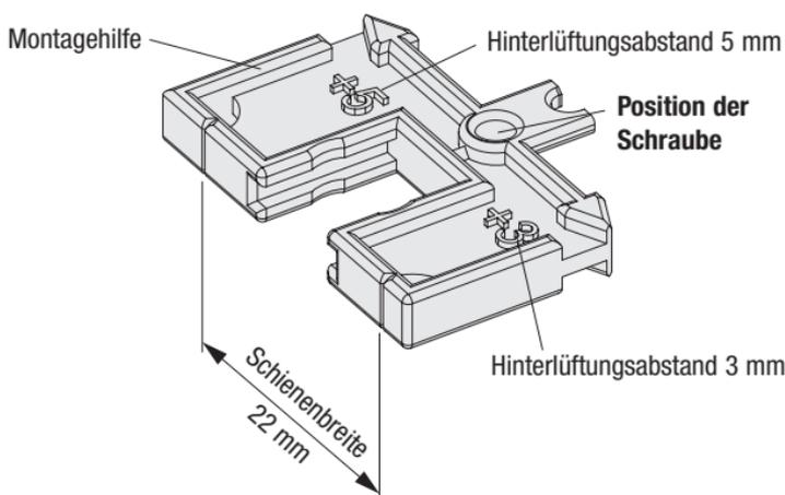
**Montagehilfe auf der Glasleiste positionieren**
