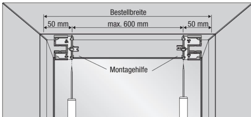
**Montagehilfe entfernen und Clips festschrauben.**
