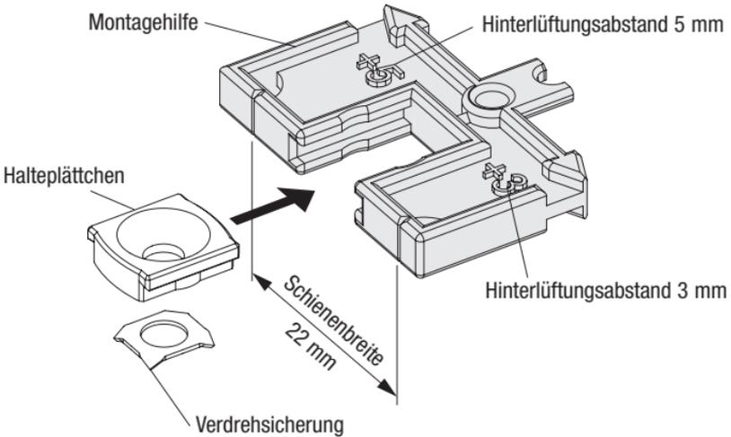
**Montagehilfe auf der Glasleiste positionieren**
